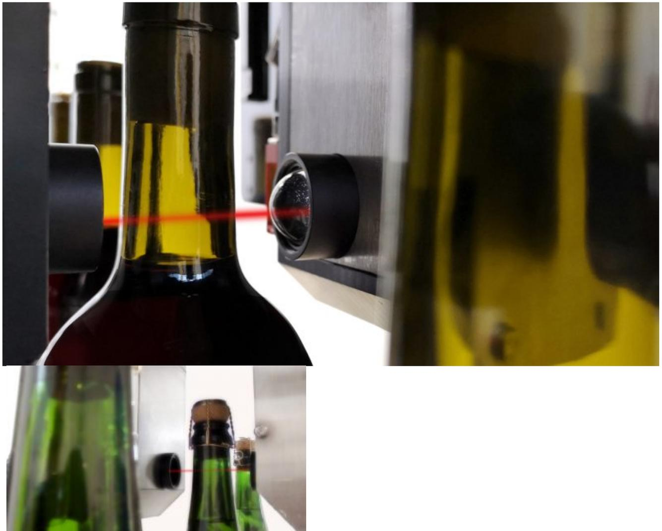
L'innovativo sistema ottico sviluppato da [Antares Vision](#) Group con tecnologia FT System permette di misurare la concentrazione dei gas direttamente in linea subito dopo la tappatura. Ma le applicazioni riguardano anche altre bevande
