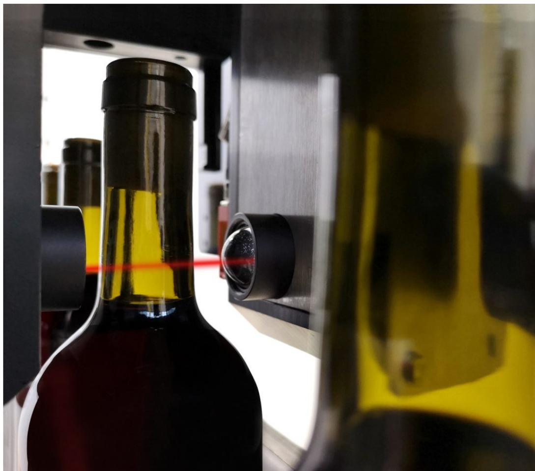
Un **raggio laser**, posizionato alla giusta altezza sulla linea di produzione, attraversa la bottiglia nello spazio di testa, tra il tappo e il livello del vino (Head Space Oxygen-HSO), sfruttando la proprietà fisica di alcune molecole allo stato gassoso che assorbono la luce solo per specifiche e definite lunghezze d'onda. Un controllo che non appesantisce il processo di produzione, perché può essere effettuato **direttamente sulla linea di**
